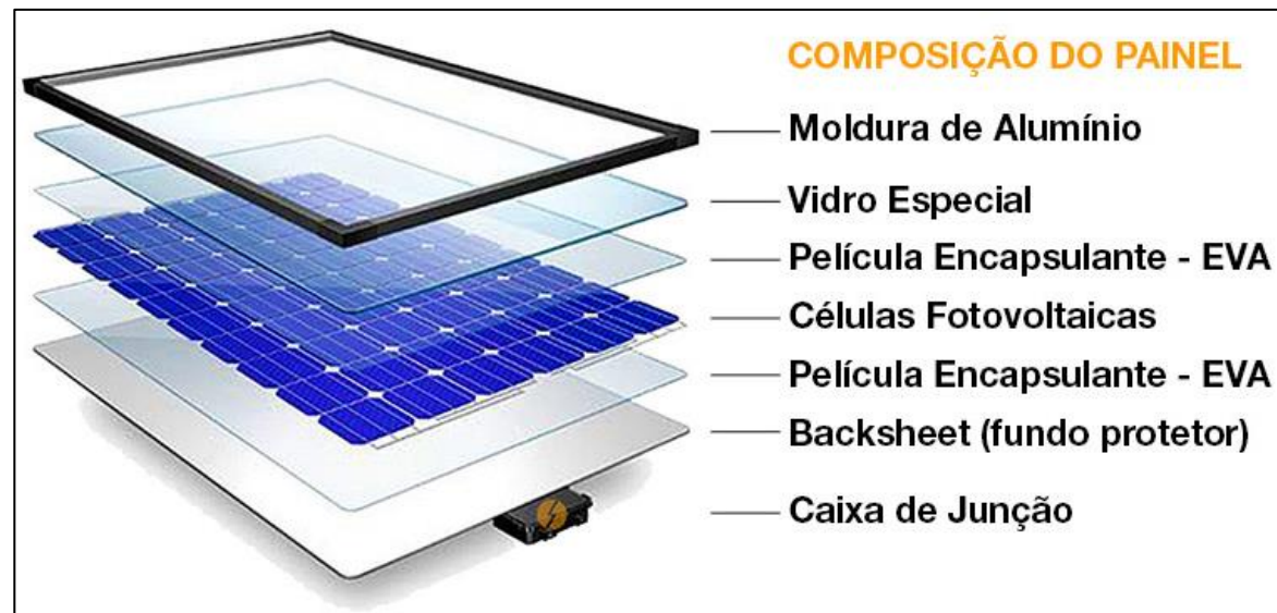
Figura 35: Composição do Painel Fotovoltaico
