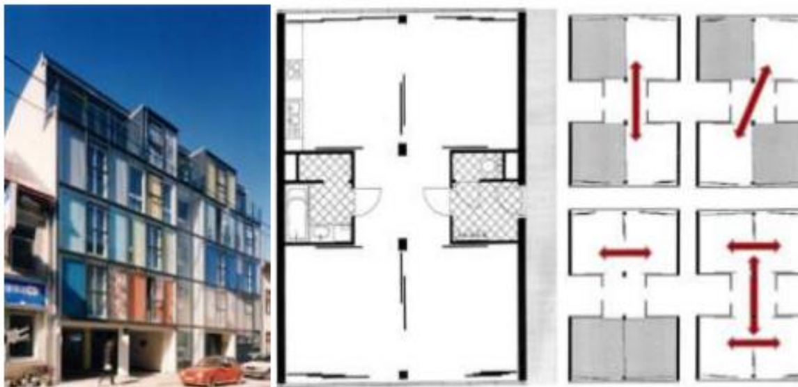
Figura 15: Edifício em Grieshofgasse: a) Vista exterior do edifício; b) Planta tipo; c) Combinações espaciais possíveis
