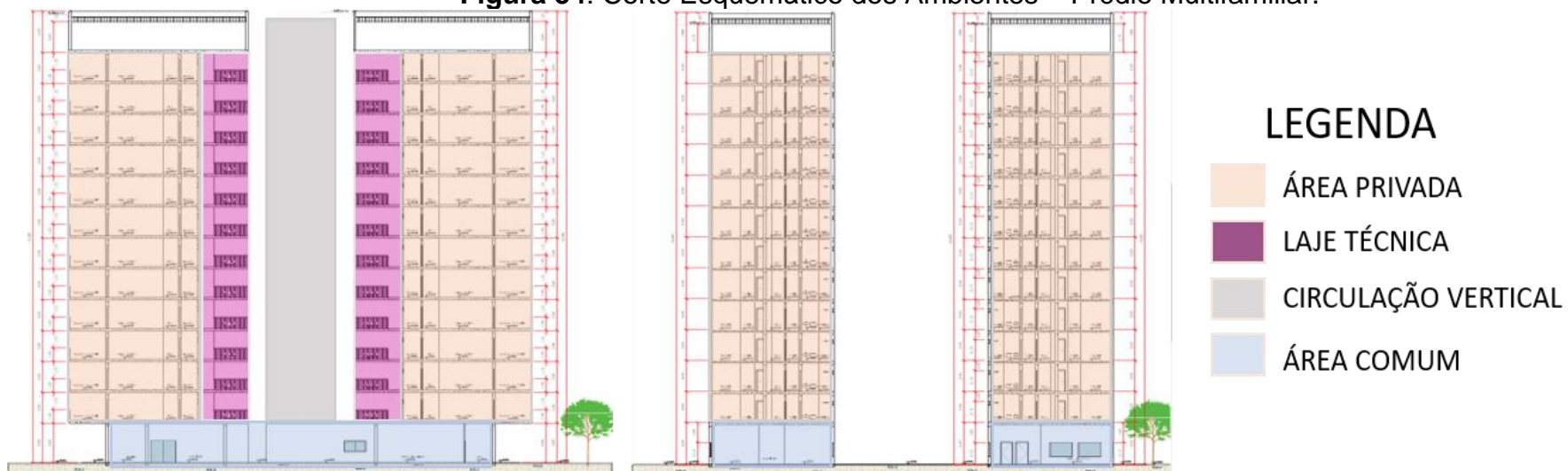
Figura 54: Corte Esquemático dos Ambientes – Prédio Multifamiliar.
