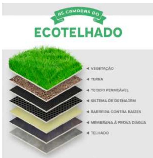
Figura 94 – Camadas do Ecotelhado.
