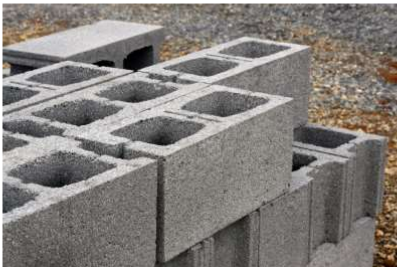
Figura 85 – Bloco de concreto.
