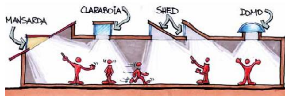
FIGURA 69: Tipologias de aberturas para luz natural
