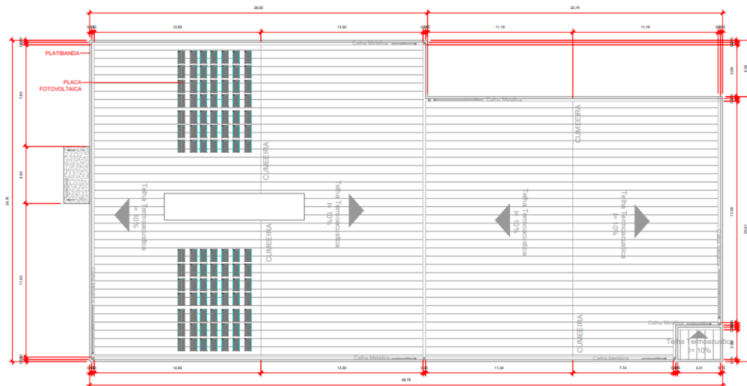
Figura 84- Planta de Cobertura Espaço Novo Tempo
