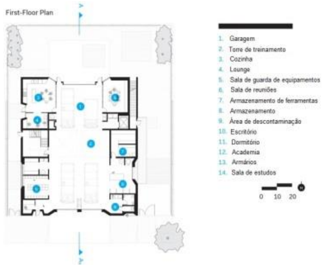
Figura 31 - Planta do primeiro pavimento
