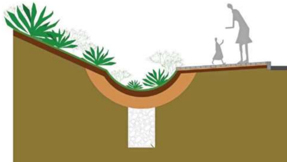
Figura 16: Corte esquemático de biovaleta.
