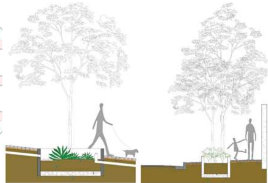
Figura 15: Corte esquemático de canteiro pluvial.
