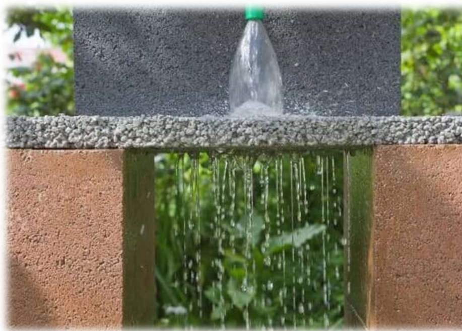
Figura 4 – Demonstração do piso drenante
