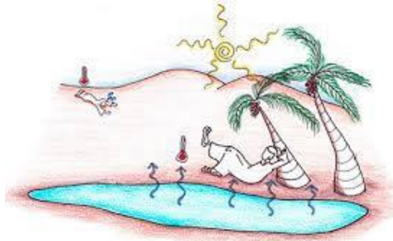
Figura 59: Esquema de resfriamento evaporativo passivo.
