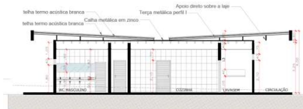
Figura 106: Corte transversal A/A Setor serviços
