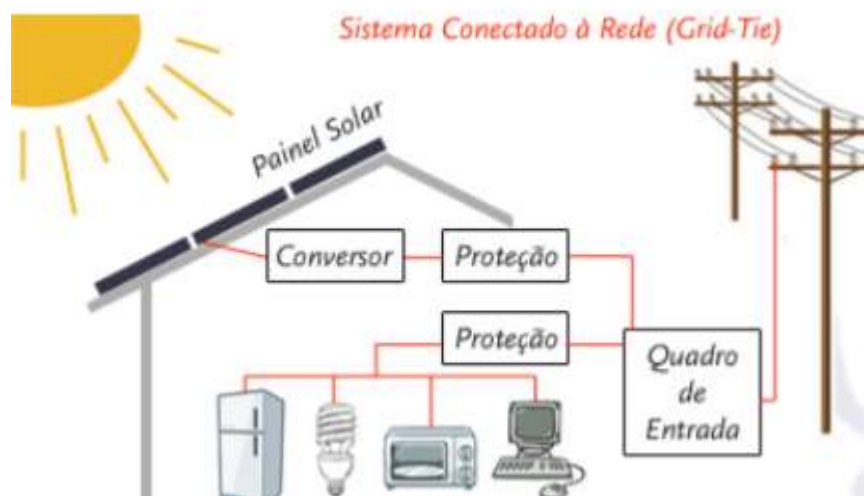
Figura 69: sistema fotovoltaico conectado à rede.
