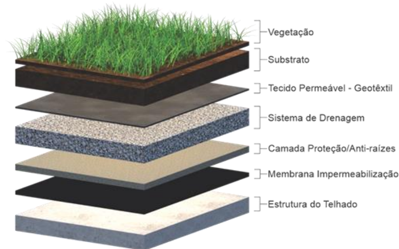
Figura 72 – Esquema de camadas da cobertura verde.
