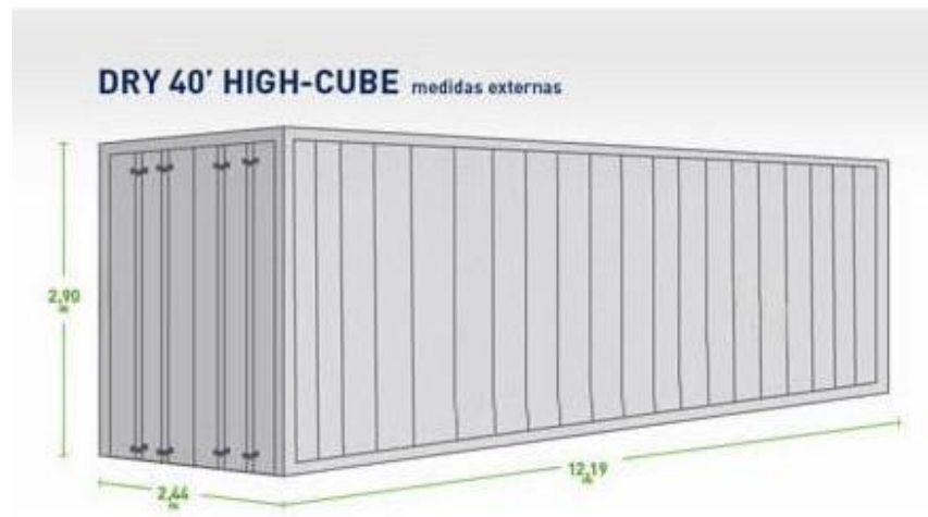
Figura 81: Dimensionamento contêiner marítimo
