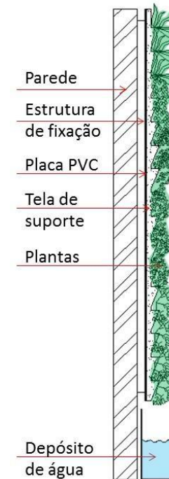
Figura 89: Detalhamento jardim vertical
