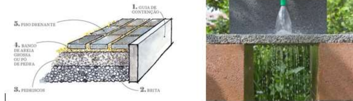
Figura 55 - Piso drenante e suas camadas
