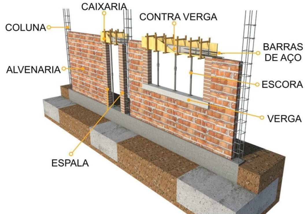
Figura 57 - Parede de alvenaria
