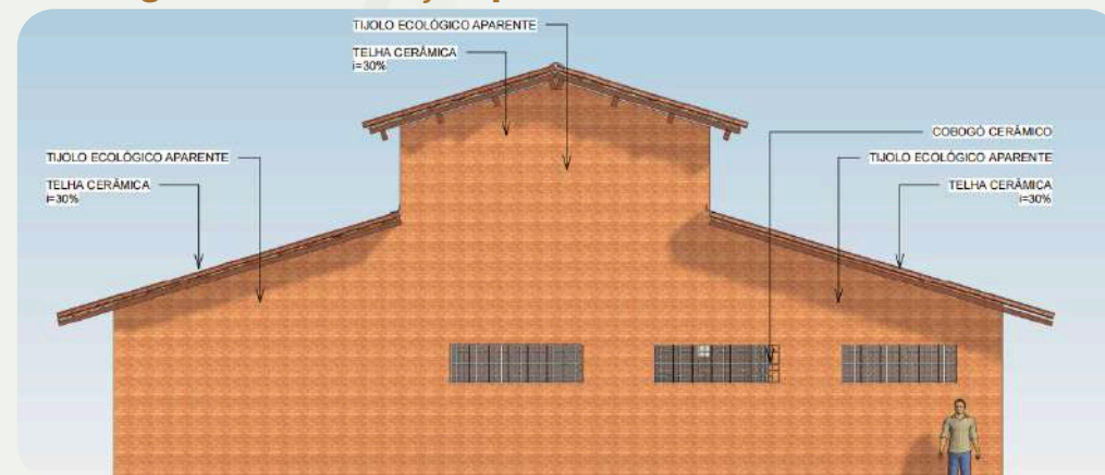
Figura 111: Elevação posterior Bloco ed. ambiental
