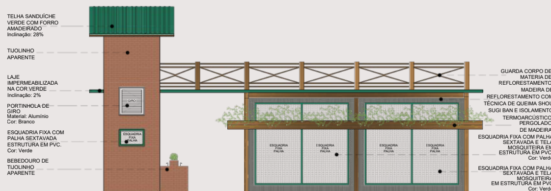
Figura 104: Fachada Posterior - Ponto de Apoio - Tipo 02
