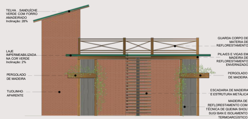
Figura 103: Fachada Lateral Esquerda - Ponto de Apoio - Tipo 02
