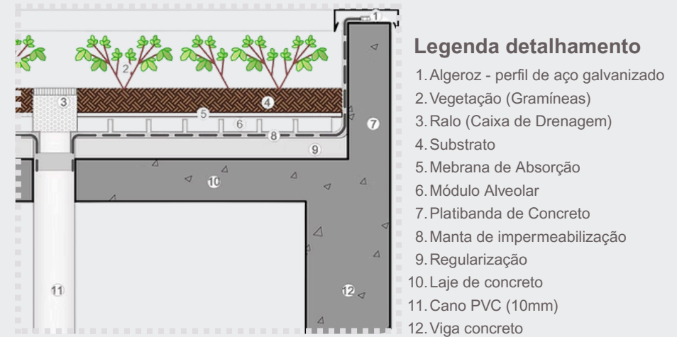
Figura 58 - Detalhamento Telhado verde
