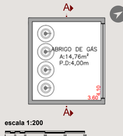
Figura 67 - Planta Layout Abrigo de Gás
