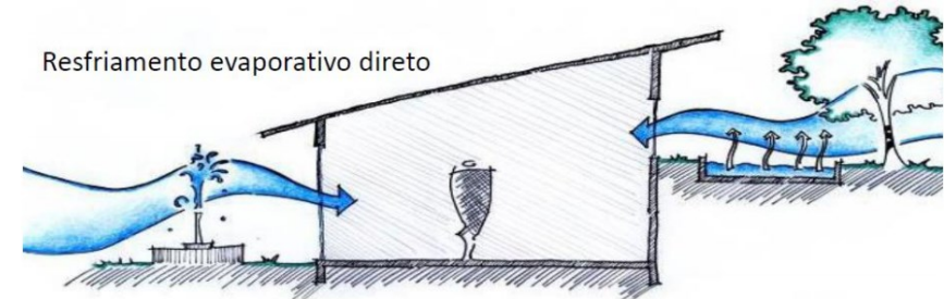
Figura 28: Ilustração de resfriamento evaporativo direto
