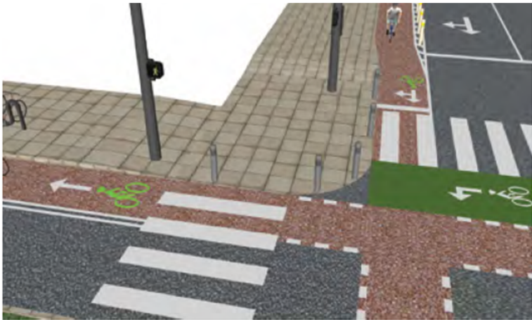
Figura 20- Exemplificação de intersecção de uma ciclofaixa
