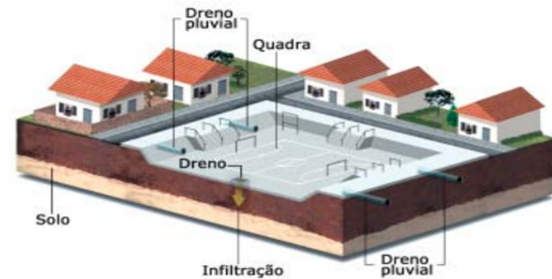
Figura 7 - Praça de esportes, sendo usada como bacia de retenção.
