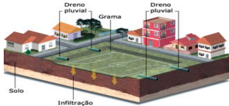
Figura 6 - Campo de futebol utilizado no período de chuva como bacia de retenção.
