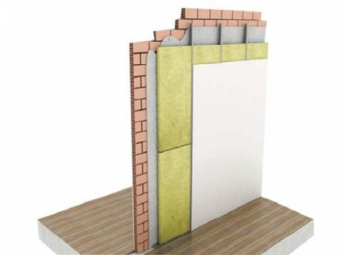
Figura 55: Parede Drywall com tratamento acústico lã de vidro Fonte: Disponível em: http://www.speeddry.com.br/isolamento-acustico-drywall . Acesso em 14 set 2018.
