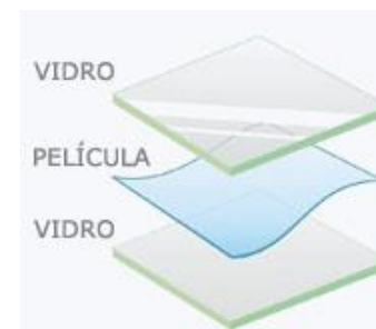
Figura 32: Composição do Vidro temperado laminado
