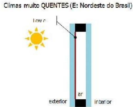
Figura 63 - Esboço orientativo para instalação do vidro insulado.
