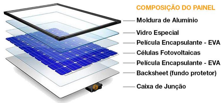
Figura 53: Composição de um Painel Fotovoltaico.
