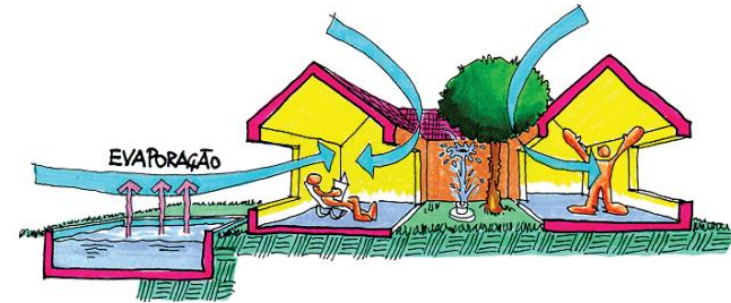
Figura 47: Exemplo de resfriamento evaporativa através de fontes e espelhos d’água.
