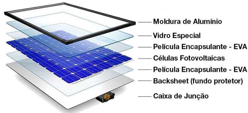
Figura 58 - Composição do Pannel Solar Fotovoltaico
