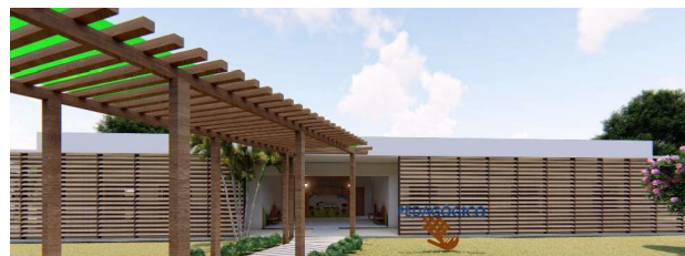
Figura 50: Brises horizontais móveis nas fachadas das edificações internas
