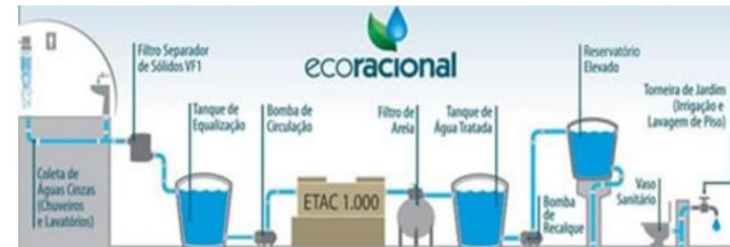
Figura 31. Sistema de Reutilização de Águas Cinzas
