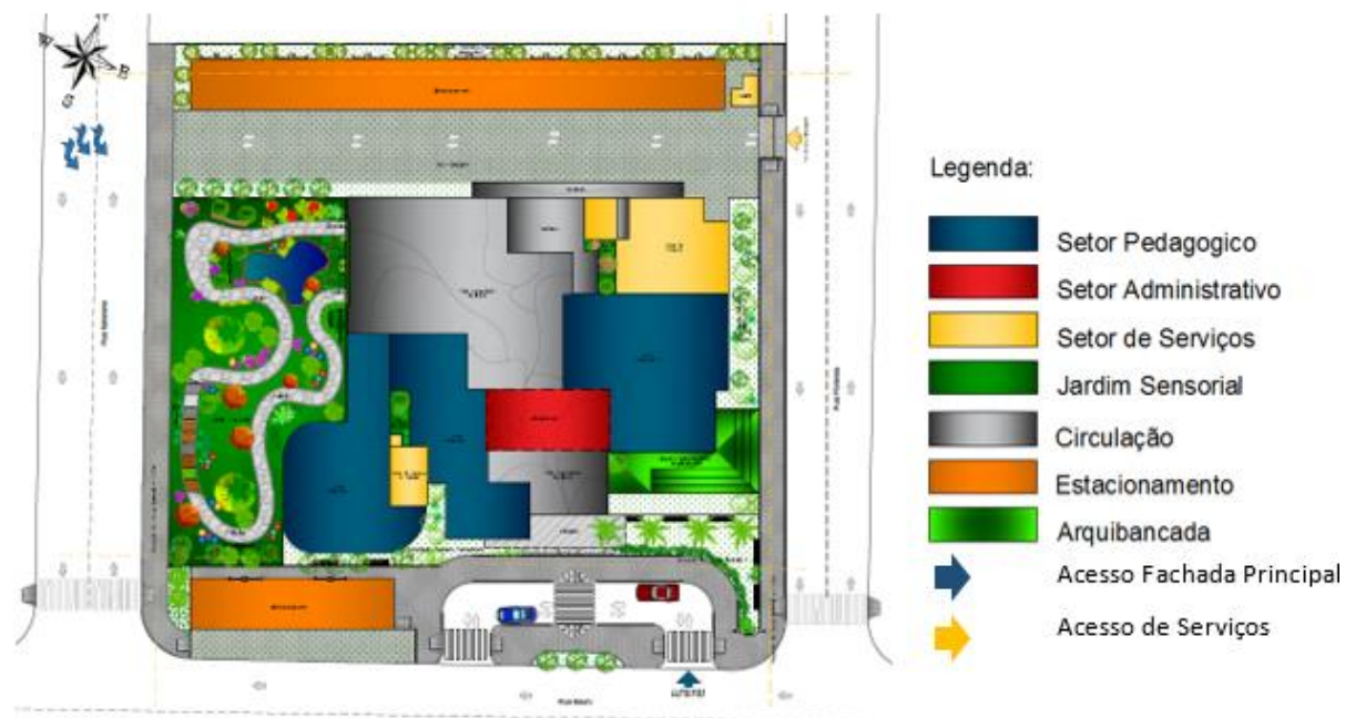
Figura 30 - Planta de Setorização. Fonte: Acervo do Autor.
