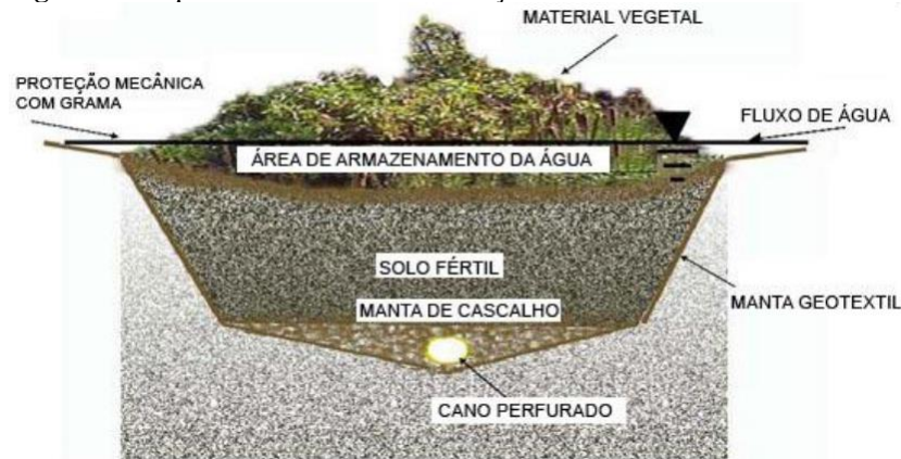
Figura 2 - Esquema de bacia de biorretenção
