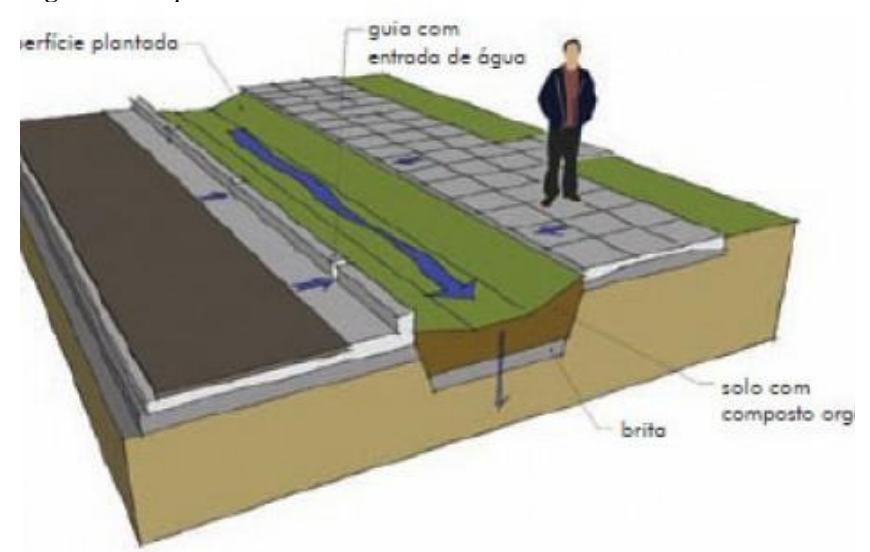
Figura 3 - Esquema de biovaleta
