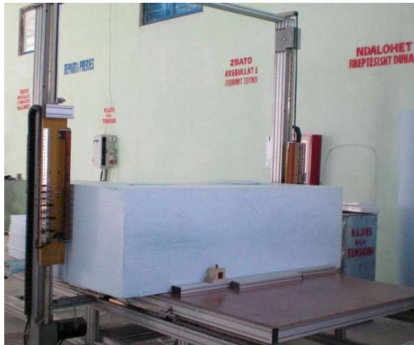
Figura 51 – EPS posicionado na máquina de corte
