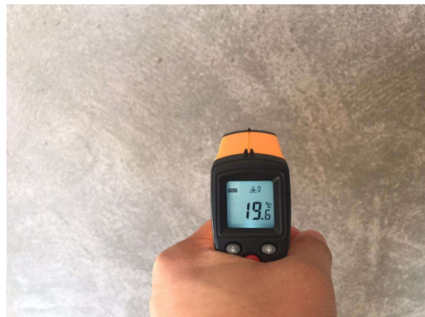
Figura 109 – Aferição de temperatura interna com o termômetro digital infravermelho
