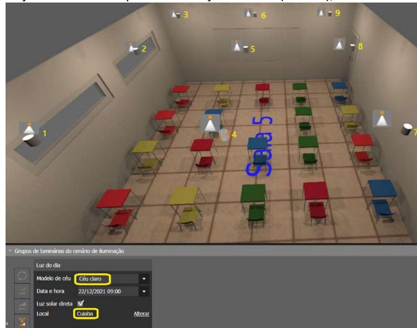
Figura 39: Configuração do ambiente para a simulação da IASP (sala 05), solstício de verão às 9h.
