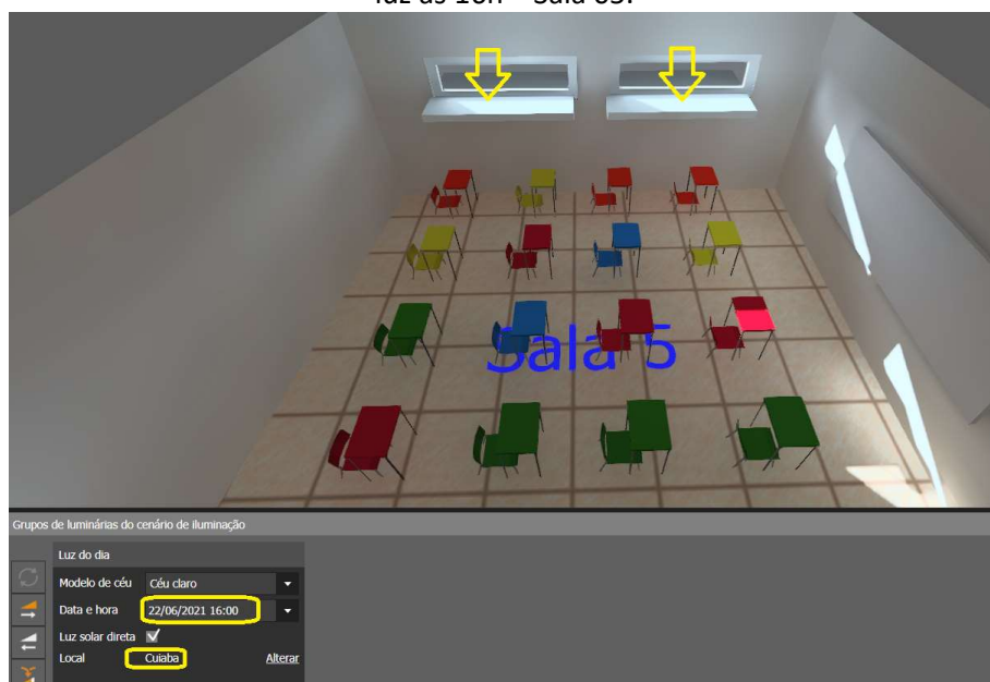
Figura 35: Configuração do ambiente para a simulação da luz natural no inverno com prateleiras de luz às 16h – Sala 05.
